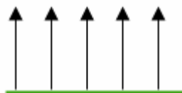
Obrázek č. 10: Normálové vektory rovného povrchu
