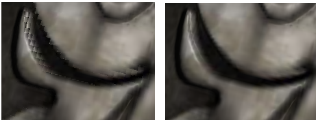
Obrázek č. 31: Porovnání detailu zobrazení metodou parallax mapping s filtrací výškové mapy metodou nejbližšího souseda (vlevo) a s bilineární filtrací (vpravo)
